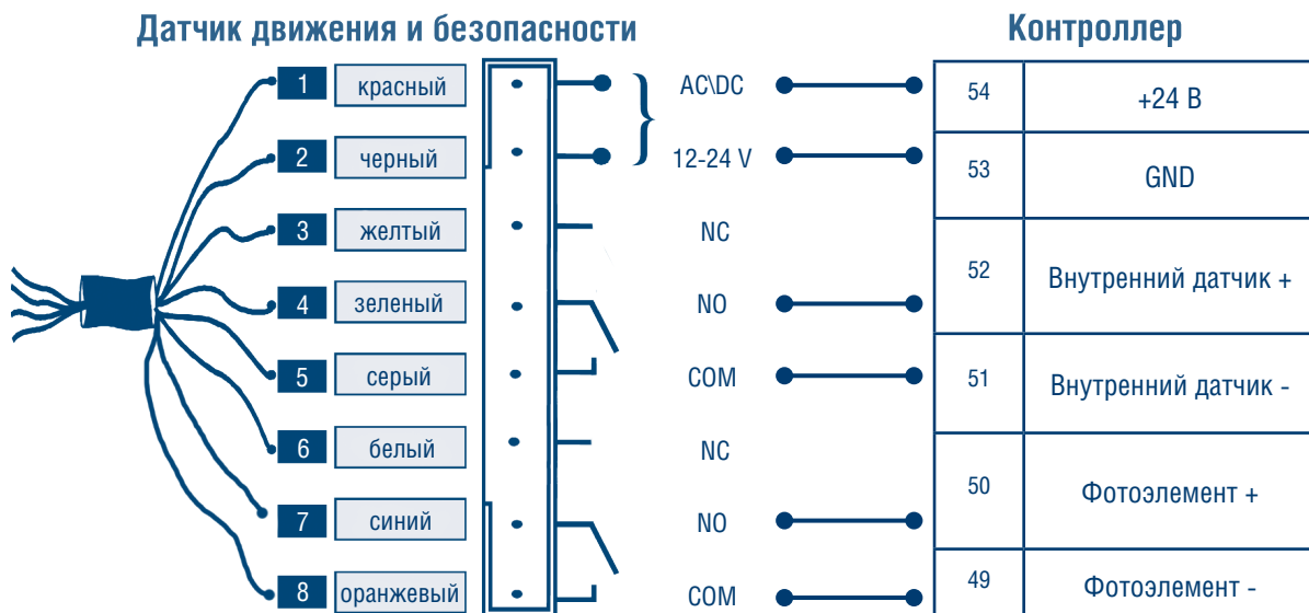
Рис. 3.1. Схема подключения датчика к приводу AD-SP восьмижильным кабелем
